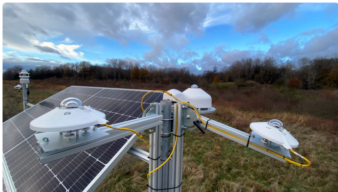
Estação de medição autônoma no site. Irradiação em várias orientações, temperatura, umidade e variáveis microclimáticas, registradas a cada cinco minutos.
