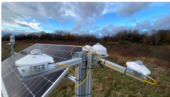
场址上的自主测量站。多朝向辐照、温度、湿度及微气候变量，以五分钟间隔连续记录。
