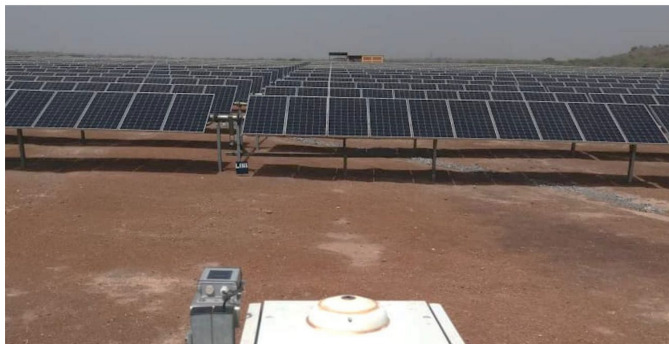
Estação de medição e campo FV em Loulo. As câmeras fisheye hemisféricas instaladas em torno da usina captam formações de nuvens que a imagem de satélite e os sensores de irradiância não resolvem.
