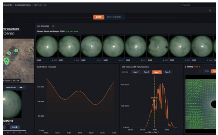
左图：Loulo 控制室，SCADA 系统图与 INSTANT 相机墙接入能量管理系统。右图：INSTANT 实时仪表盘，九台全天空成像仪、30 分钟预报、分相机 GHI 与云移动矢量。
